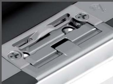
Unser Falleneinsatz mit seinem optimierten Einlaufstück sorgt für eine sanfte Schließung der Tür. Mit einer Rastung in 1 mm-Schritten lässt sich der Falleneinsatz  $\pm 3$  mm nach vorne und hinten verstellen und bietet somit nie dagewesene Einstellmöglichkeiten. Für zusätzlichen Schließkomfort sorgt die neue Flüsterfalle
